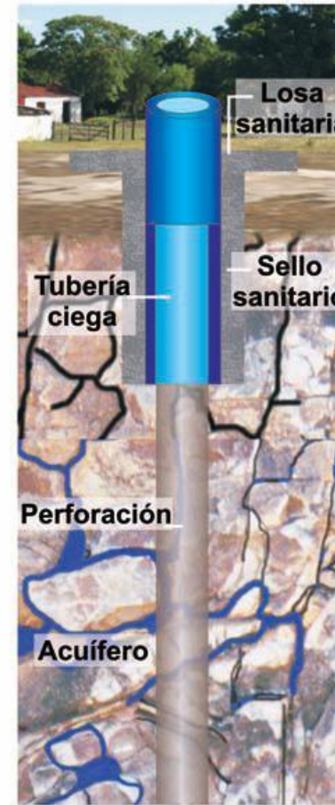
Pozo en acuífero fisurado
