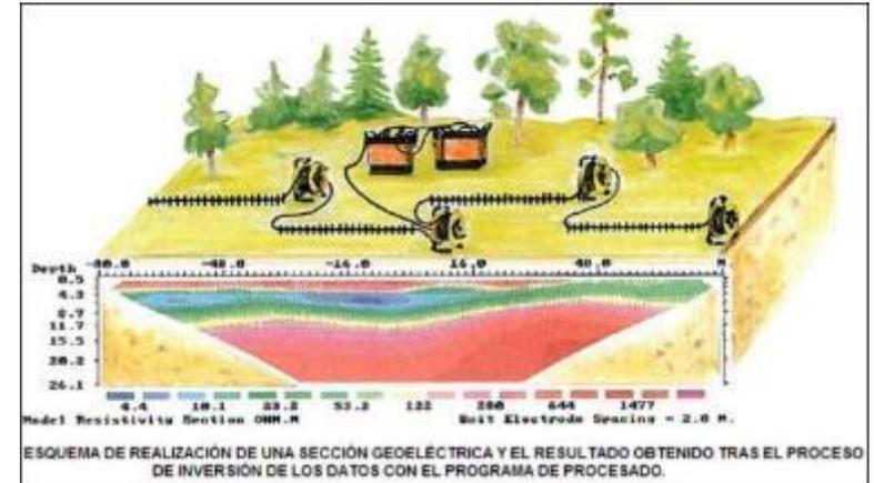
Figura 13. Esquema de realización de una sección geoelectrica y el resultado obtenido tras el proceso de inversión de los datos con el software correspondiente. Fuente: <http://geotecniayproyectos.blogspot.com>.
