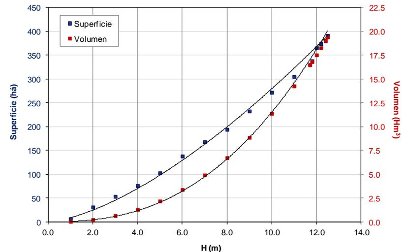
**Obs:** La curva de almacenamiento-área puede modificarse luego de su construcción debido a la sedimentación en el embalse.
