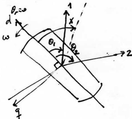
Observaremos las ejes de simetría (ejes de flujo) de esos polos, caracterizados por los ángulos  $\theta_1$  y  $\theta_2$ , mientras que la posición de un punto genérico del estator estará caracterizada por el ángulo  $x$ .
