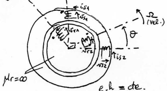
Tengo 2 bobinas en cuadratura en el estator y otras 2 H. en cuadratura en el rotor, formando un áng.  $\theta$  con las otras.
