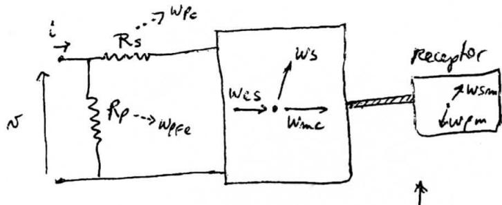
Puedo colocar toda la masa, el momento de inercia, del lado del receptor (representa la  $\omega_{mecc.~util}$  (?) )
