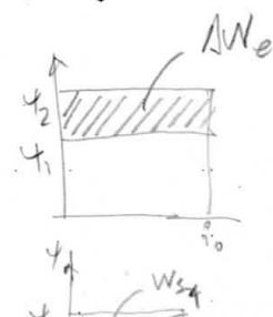
$$F_m = \text{fuerza media durante el desplazamiento} = \frac{\Delta W_m}{(x_2 - x_1)} = \frac{\Delta W_e - \Delta W_s}{x_2 - x_1}$$
