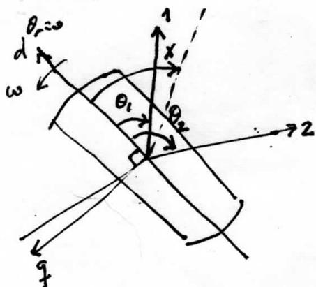
Observaremos los ejes de simetría (ejes de flujo) de estos bobinas, caracterizados por los ángulos  $\theta_1$  y  $\theta_2$ , mientras que la posición de un punto genérico del estuche exterior estará caracterizada por el ángulo  $x$ .
