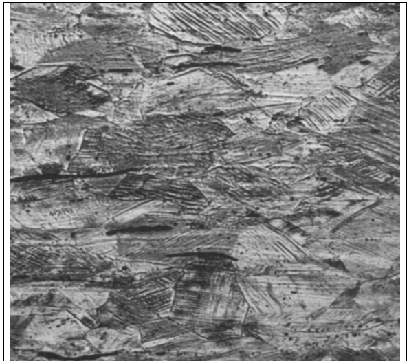
Figura 25: Formación de martensita en acero austenítico deformado
