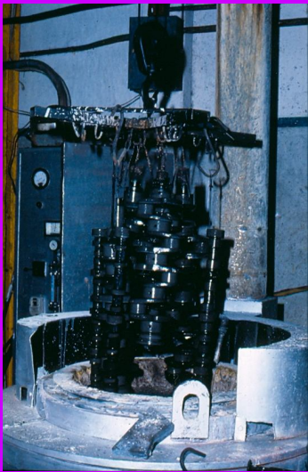
Retirando del baño para enfriar
