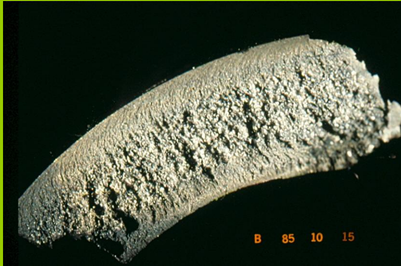
Fractura de un perno
