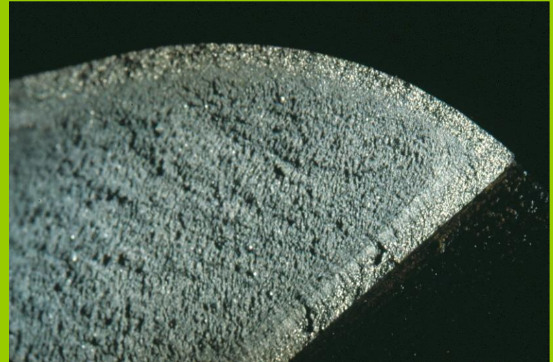
Fractura para control de avance de cementación
