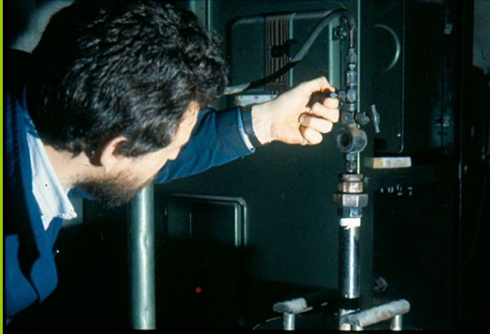
Apertura de caída del hidrocarburo
