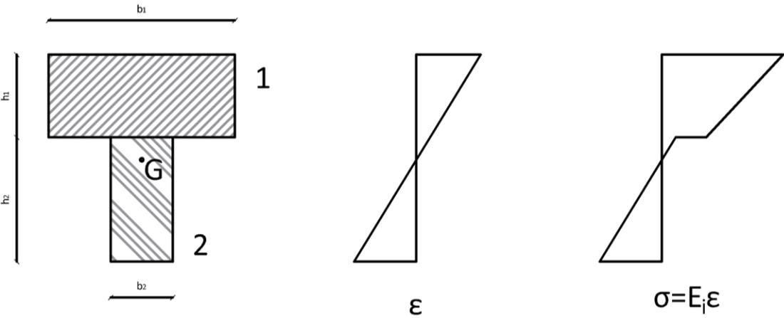
Al ser las deformaciones unitarias lineales, el diagrama de tensiones normales será lineal también (considerando la ley de Hooke). Se produce un salto en el diagrama de tensiones normales producido por el cambio de modulo elástico.
