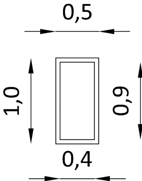
La sección presenta dos ejes de simetría por lo que ya conocemos la posición del baricentro, procedemos entonces a calcular la inercia de la sección:
