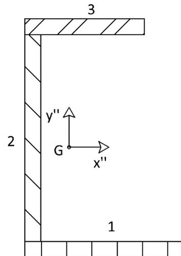
Una vez calculada la posición del baricentro, pasamos a calcular los momentos de inercia respecto a los ejes  $x''$  e  $y''$ . Utilizamos para esto el teorema de Steiner.
