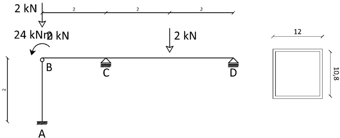
La estructura está construida en aluminio ( $E = 70 \text{ GPa}$ ) y se consideran deformaciones por directa. Las unidades de la sección están dadas en centímetros.
