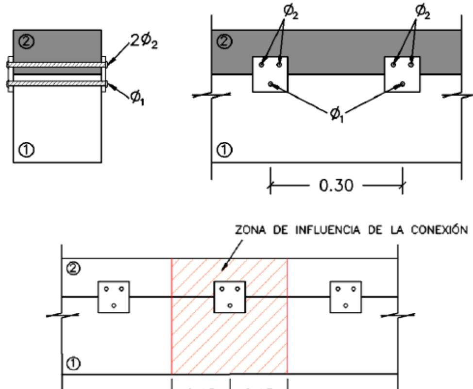
$$F_{\text{conexión}} = \tau \cdot b \cdot s = 1.05 \frac{\text{kN}}{\text{cm}} \cdot 30 \text{ cm} = 31.5 \text{ kN}$$
