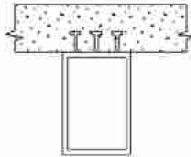
**Viga compuesta con perfil de acero en cajón**
