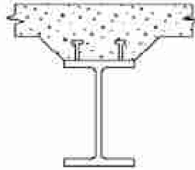
**Losa reforzada en la zona de la unión con la viga**
