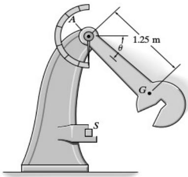
2) El péndulo de la máquina de ensayos Charpy tiene una masa de 50 Kg y un momento de inercia de 1,75 Kg m<sup>2</sup>.
