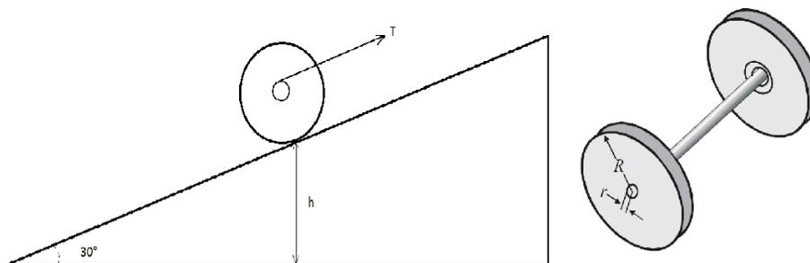
El objeto de la figura está constituido por dos discos uniformes, cada uno de masa  $M$  y radio  $R$ , unidos por un eje cilíndrico uniforme de masa  $m$  y radio  $r$ .
