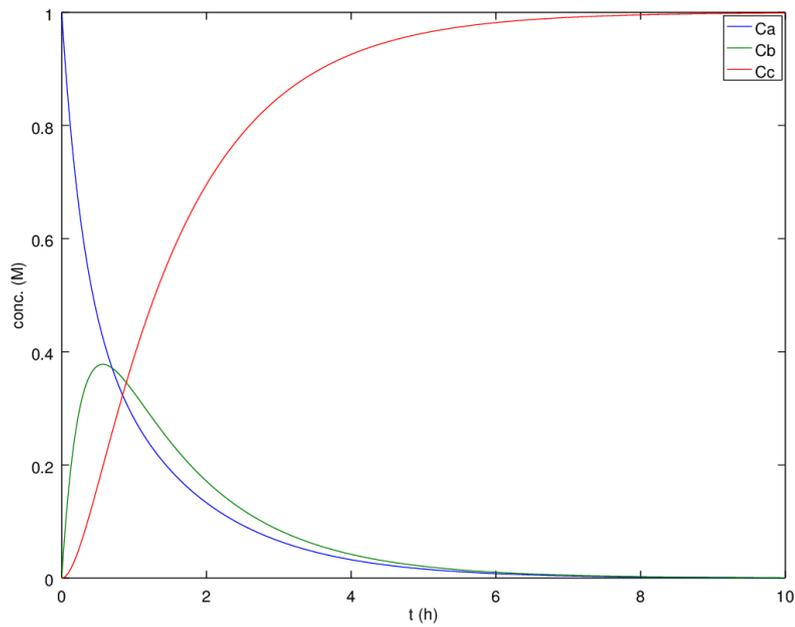
$t_{Cbmax} = 0.57 \text{ h}$  (precaución discretizar suficientemente el vector t).
