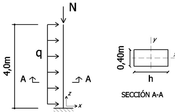
El pilar de la figura está sometido a una directa centrada  $N_d = 5000 \text{ kN}$  y una carga distribuida uniformemente sobre su eje, según  $x$ ,  $q_{x,d} = 20 \text{ kN/m}$ .
