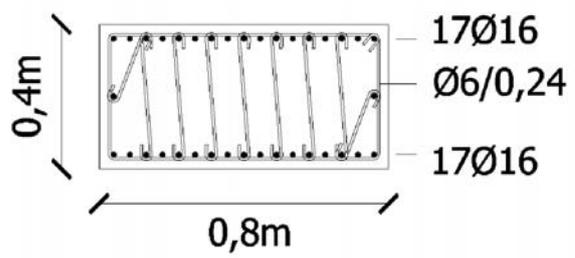
Se colocan 2 barras adicionales en los lados cortos para cumplir con las separaciones máximas permitidas por norma.
