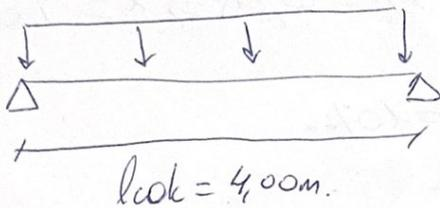
$$f_d = 1,35 f_{pp} + 1,5 f_{sw} = 48,38 \text{ kN/m}$$
