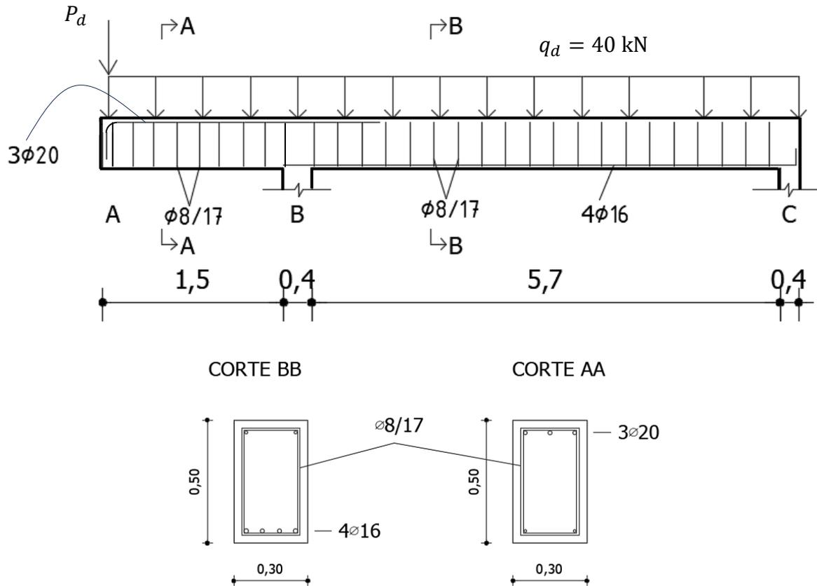
La figura muestra una viga y su armadura longitudinal estructural (superior:  $3\phi 20$  e inferior:  $4\phi 16$ ) y transversal ( $\phi 8/17$  en toda la viga) Esta es de sección rectangular de  $(30 \times 50) \text{ cm}^2$ , con una carga  $q_d$  aplicada en todo el largo de la viga y una carga  $P_d$  aplicada en el extremo A.
