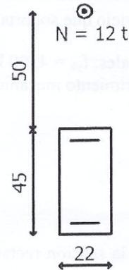
6) Sea la sección rectangular de la figura sometida a una directa de compresión en servicio de  $N = 70$ t, aplicada con una excentricidad de 5cm respecto al borde superior de la sección. Determinar la armadura longitudinal necesaria.
