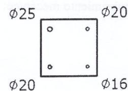
4) Sea el entepiso de la figura con vigas simplemente apoyadas de 6m de luz. Determinar para la viga de borde la armadura de flexión necesaria si se la somete a un momento flector de servicio de  $M = 17 \text{ tm}$ .
