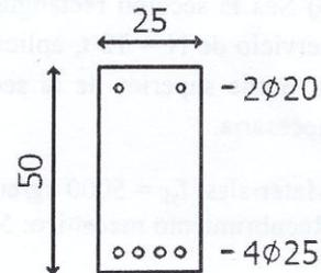
2) Sea la sección rectangular de la figura sometida a un momento de servicio de  $M = 20 \text{ tm}$ . Determinar la armadura longitudinal necesaria.
