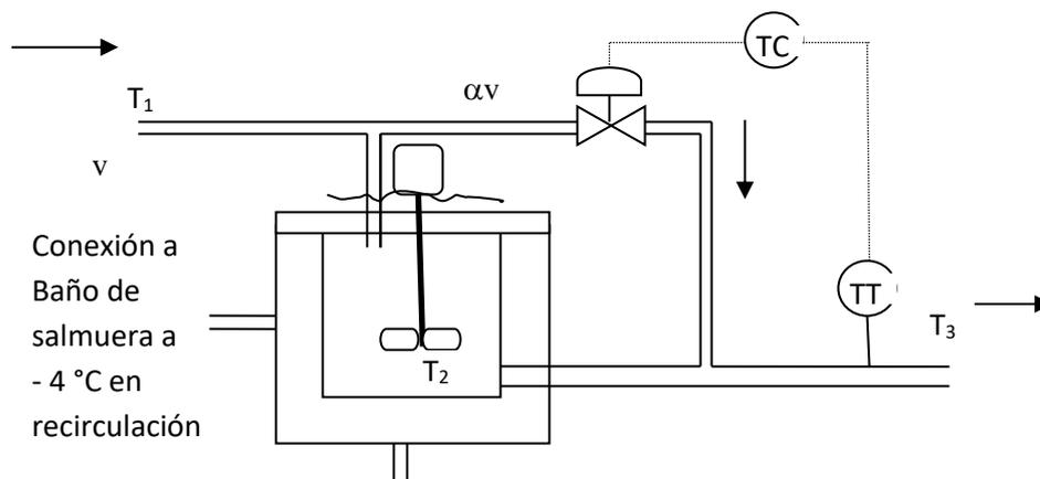
La temperatura de ingreso puede variar según los procesos aguas arriba, pero se requiere una  $T_3 = 15\text{ }^\circ\text{C}$  para lo que sigue. Puede asumirse que el caudal  $v = 4,7\text{ L/min}$  es constante.
