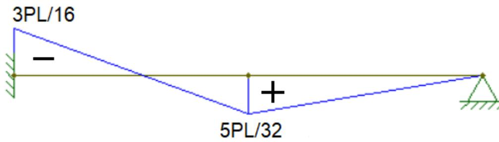
II) Para hallar el giro y la flecha en el punto medio de la viga es necesario conocer la ecuación del giro  $\theta(x)$  y la ecuación de la flecha  $v(x)$  en algún tramo de la misma que incluya el punto medio.
