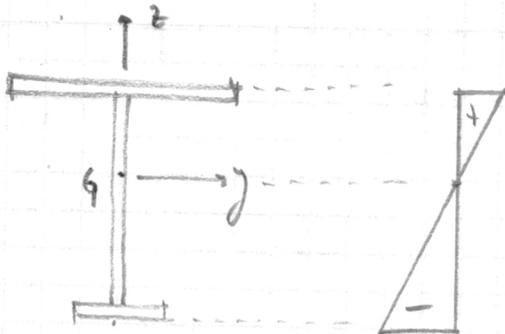
$$\sigma_{sup} = 3.065 \text{ kN/cm}^2 = 30.65 \text{ MPa (Tracción)}$$
