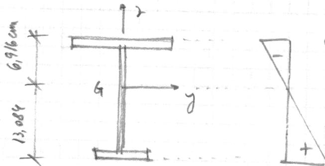
$$\sigma_{sup} = -\frac{703 \cdot 6.916}{1805.25} = -2.693 \text{ kN/cm}^2 = -26.93 \text{ MPa (Compresión)}$$
