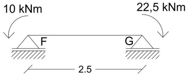
Mediante las tablas de deflexión en vigas simplemente apoyadas proporcionadas en el curso se determina la flecha generada por dichos momentos. Se toma módulo de Young  $E=210 \text{ GPa}$  y momento de segundo orden  $I=2,14 \times 10^{-5} \text{ m}^4$  (obtenido de las tablas de PNI).
