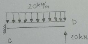
$$\delta_D^{CD} = \frac{20 \text{ kN/m} \cdot (2\text{m})^4}{8 E^a I_h} - \frac{10 \text{ kN} \cdot (2\text{m})^3}{3 E^a I_h}$$
