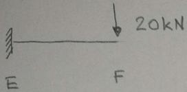
$$\delta_F^{EF} = \frac{20 \text{ kN} \cdot (1 \text{ m})^3}{3 E^a I_h} \rightarrow \delta_F^{EF} = 1,803 \text{ mm}$$
