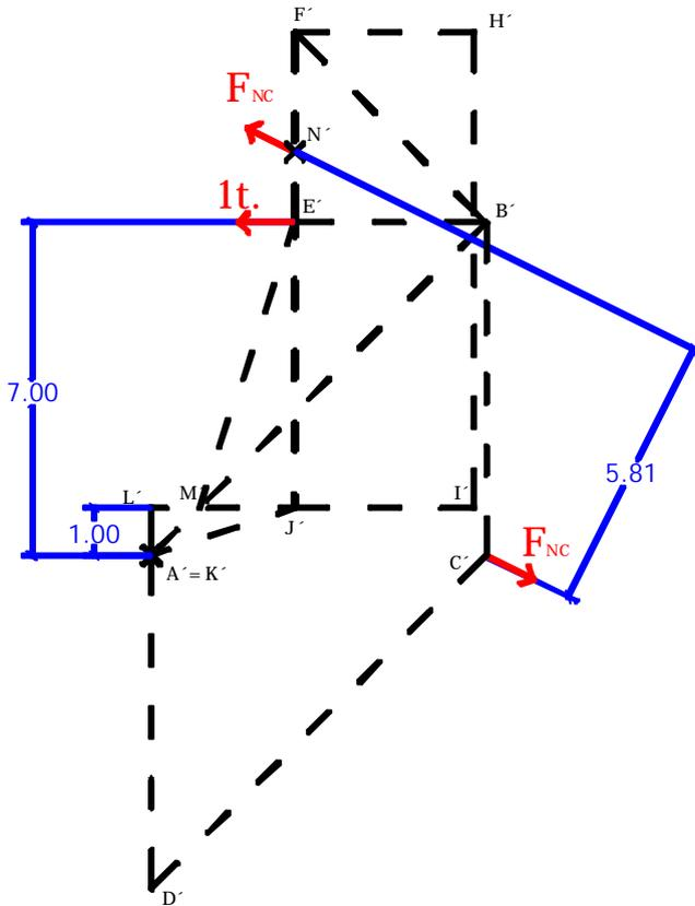
Para calcular el Esfuerzo en la barra CN, utilizo nuevamente el PTV para aprovechar el diagrama que ya realicé. Coloco una fuerza en la dirección que haría la barra que agrego, calculo trabajo (mediante los momentos, ya que utilizo la palanca de Yucovski) e igualo a cero.
