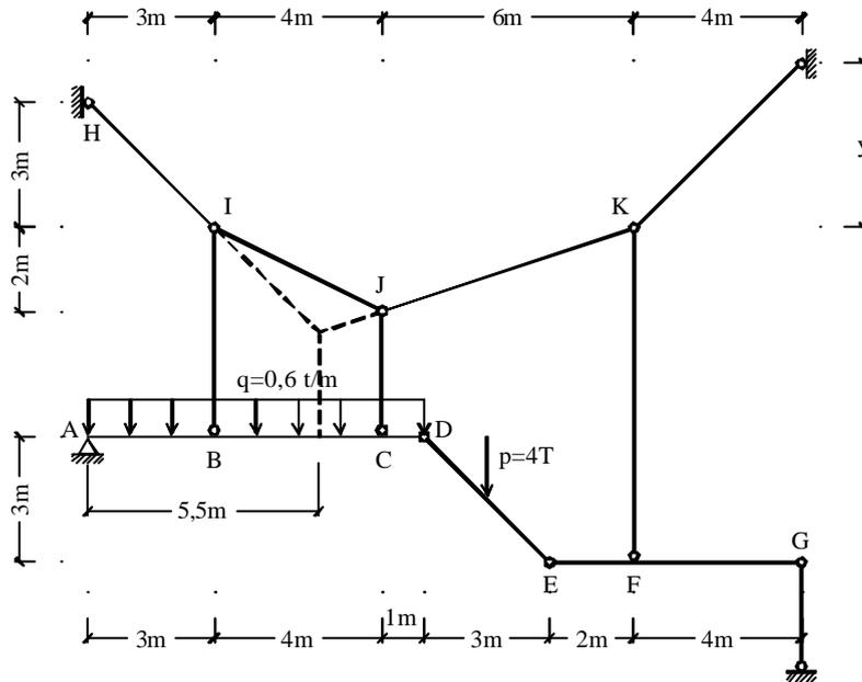
a) Como el cable es una funicular, sabemos que la resultante de las fuerzas en los tensores IB y JC va a estar en el corte de los cable HI y JK.
