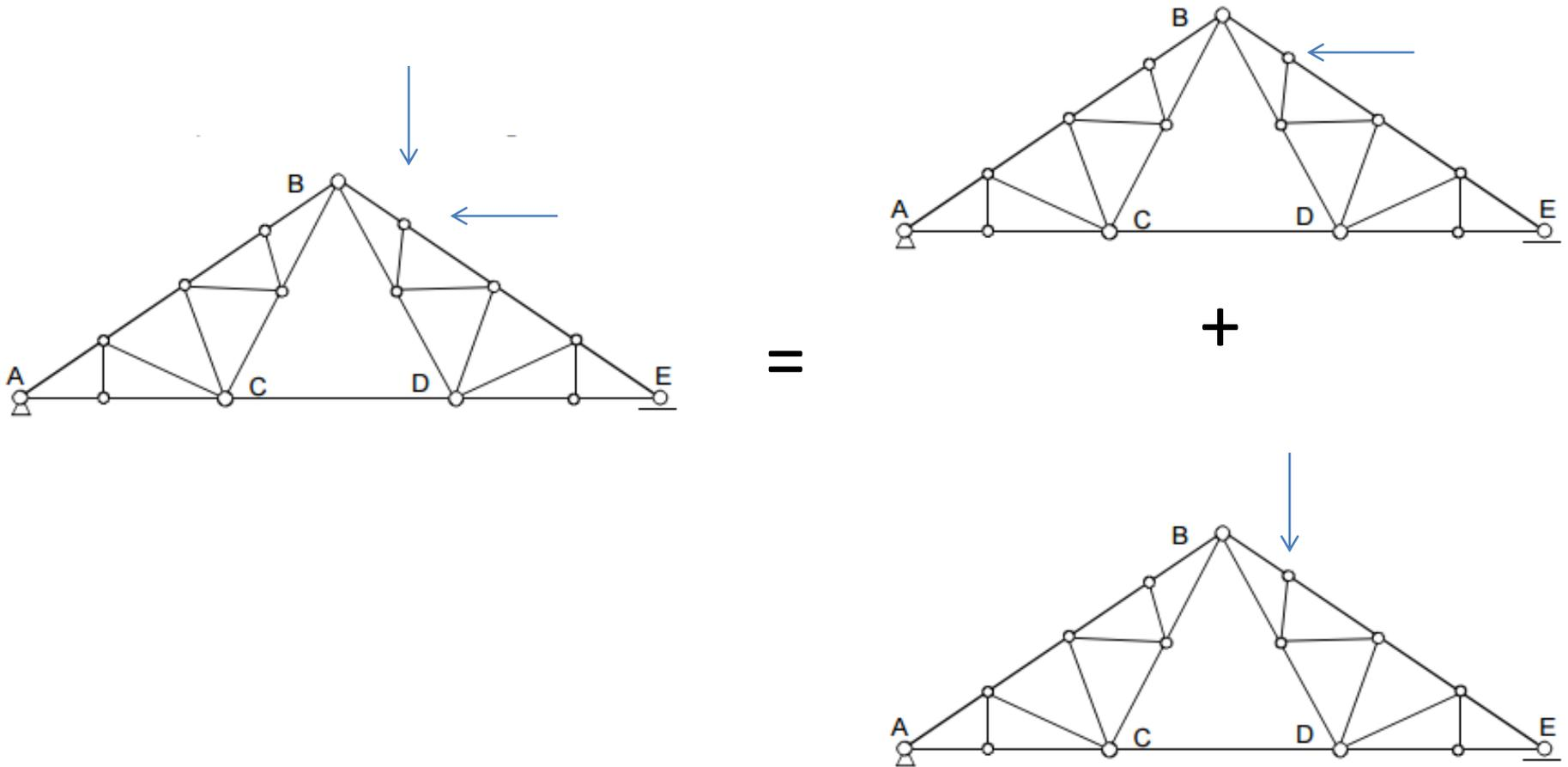
Este principio se cumple para condiciones de linealidad y elasticidad de los materiales. Es válido para calcular las reacciones, las solicitaciones y las tensiones.
