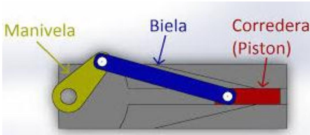
Respecto a las reacciones y desplazamientos que permiten, un **apoyo deslizante** es “equivalente” a una **biela**.
