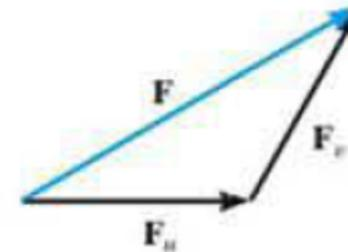
(Se puede simplificar, dibujando medio paralelogramo: triángulo de fuerzas)
