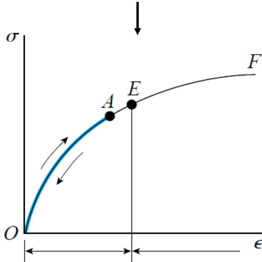
Material **parcialmente elástico**: durante la descarga la barra recupera parcialmente la forma original.
