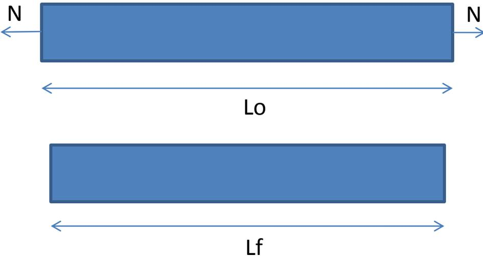
En el caso de una barra de sección o carga variable a lo largo del eje, la deformación unitaria puede variar punto a punto a lo largo del eje. Es necesario definir, en forma general, la deformación unitaria para cada punto.
