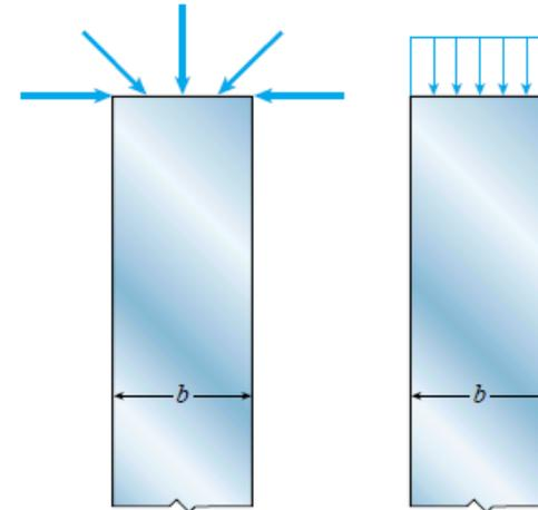
En R1 vamos a despreciar el efecto de introducción de carga, por lo que supondremos que la fórmula  $\sigma = P/A$  es válida para toda sección de la barra.
