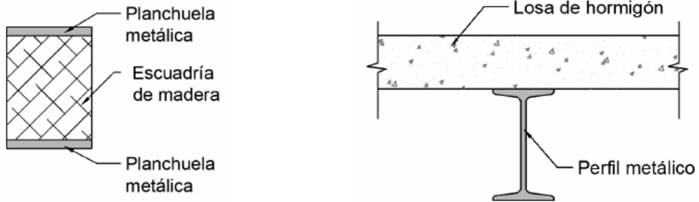
**Figura 1: Ejemplos usuales de vigas con secciones compuestas**
