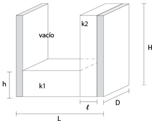
a) Calcule la capacitancia equivalente ( $C_{eq}$ ) del mismo en función de los parámetros dados.
