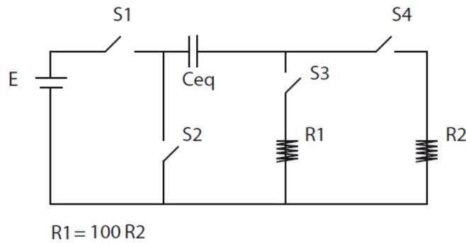
c) Al cabo de un tiempo  $T1=C_{eq}R1$  se abren las llaves S1 y S3 y se cierran S2 y S4 (simultáneamente). Transcurrido un tiempo  $T2=C_{eq}R2$  a partir de ese instante se abren S2 y S4, quedando de esta forma todas las llaves del circuito abiertas. Grafique cómo varía la carga del capacitor para todo tiempo indicando los valores relevantes en el gráfico.
