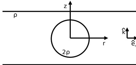
Una distribución de carga está compuesta por una distribución volumétrica uniforme de valor  $\rho$  ( $\rho > 0$ ) de ancho fijo y extensión infinita, salvo en una región con forma de esfera con distribución volumétrica uniforme de valor  $2\rho$  como se muestra en la figura. El centro de la esfera se encuentra a igual distancia de las caras de la distribución de valor  $\rho$ .
