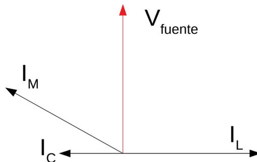
La corriente en el dispositivo M adelanta un ángulo  $\phi$  respecto al voltaje en la fuente,  $I_C$  adelanta  $90^\circ$  e  $I_L$  atrasa  $90^\circ$ . En el diagrama fasorial
