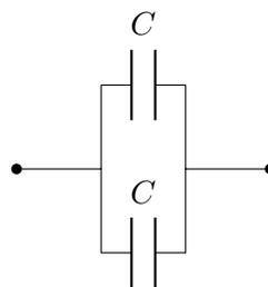
Figura 2: Conexión en paralelo
