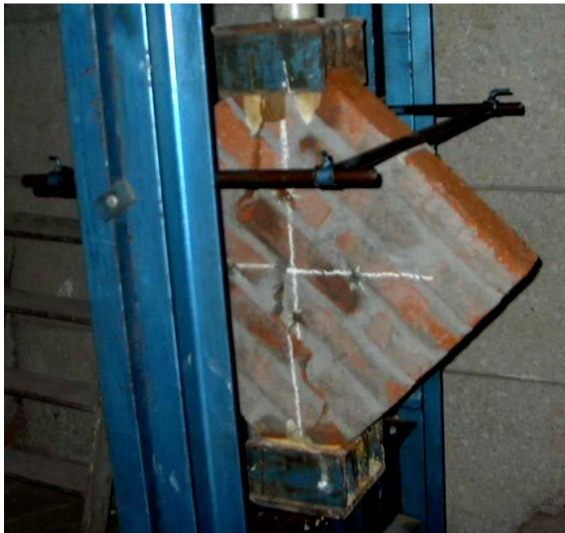
Figura 2-18 – Murete ya ensayado.
