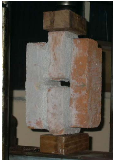
Figura 2-23 – Ensayo de Tripletas.
