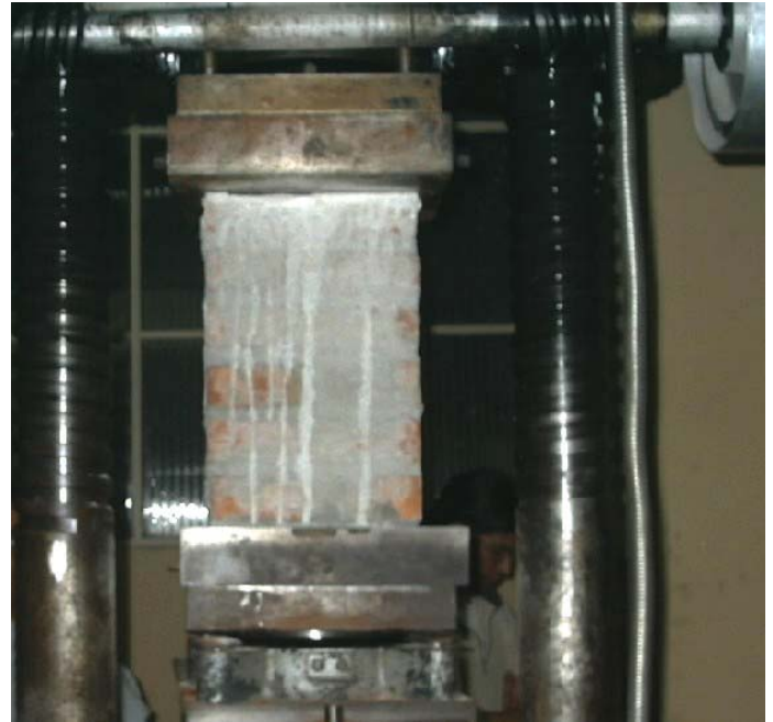
Figura 2-5 – Ensayo para la determinación de la resistencia a la compresión de la mampostería.
