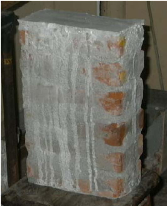
Figura 2-4 – Prisma utilizado para el ensayo de determinación de f_k
