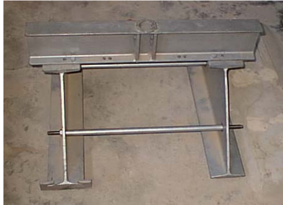
Figura 2-44 – Elemento de distribución de carga
