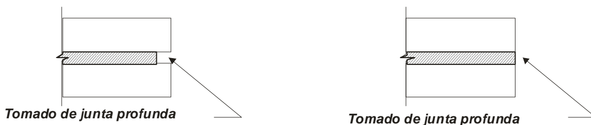
Figura C 7.1.a. Sección neta mínima de ladrillos macizos.
