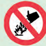
Prohibido apagar con agua
