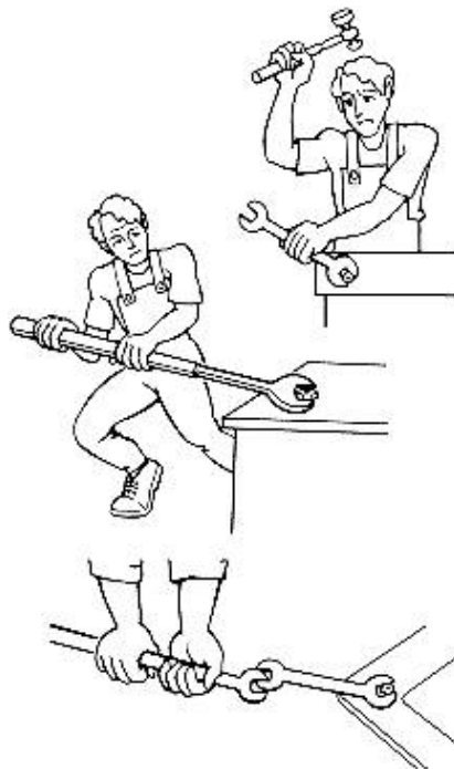
Fig. 8: Utilización de llaves inadecuadas
