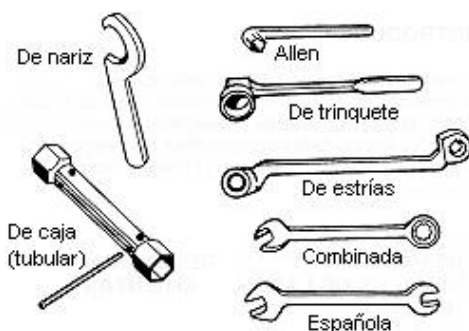
Fig. 3: Tipos de llaves de boca fija
