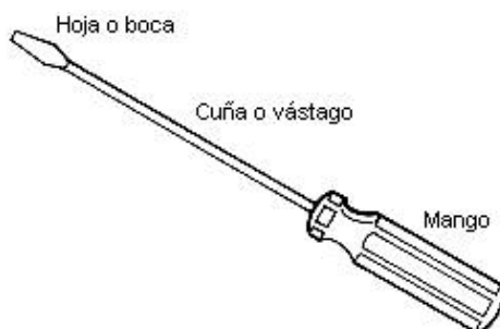
Fig. 11: Partes de un destornillador
