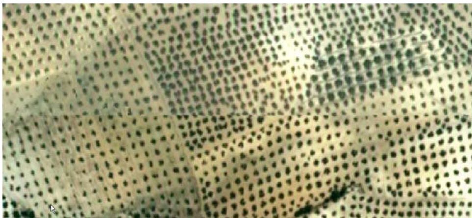
Fig. 9. Ejemplo de incidencia. Ligera discontinuidad geométrica en el contacto de hojas.
