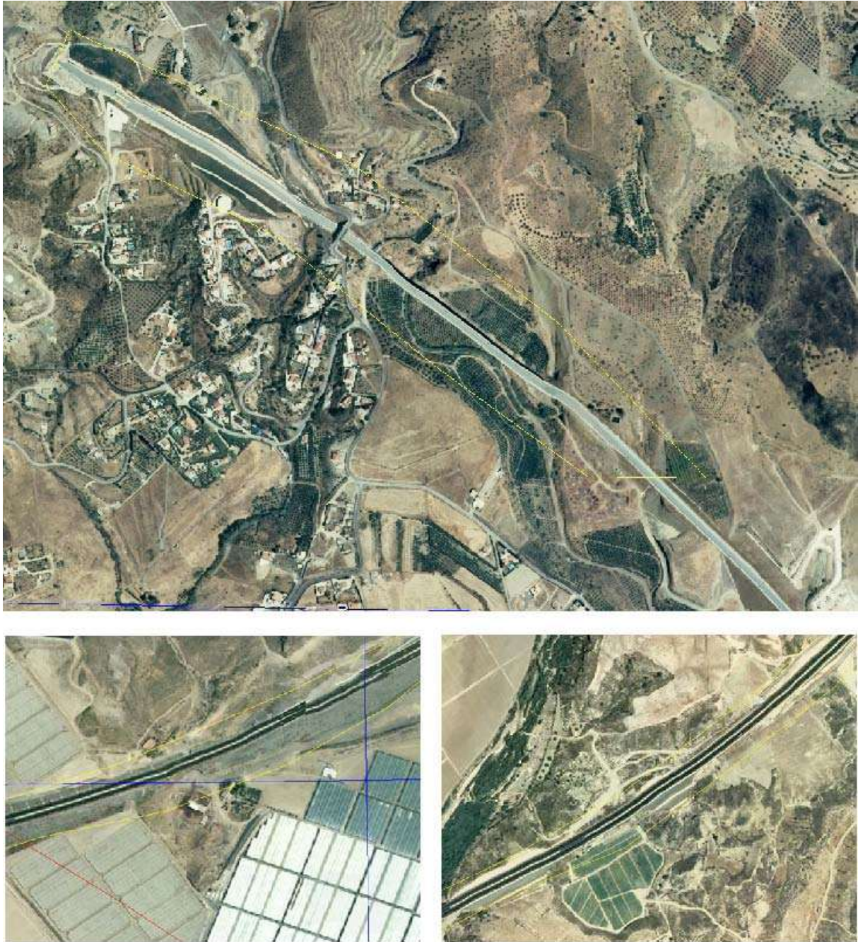
Fig. 5. Ejemplo de incidencia. Deformación en carreteras por la no actualización del MDT.
