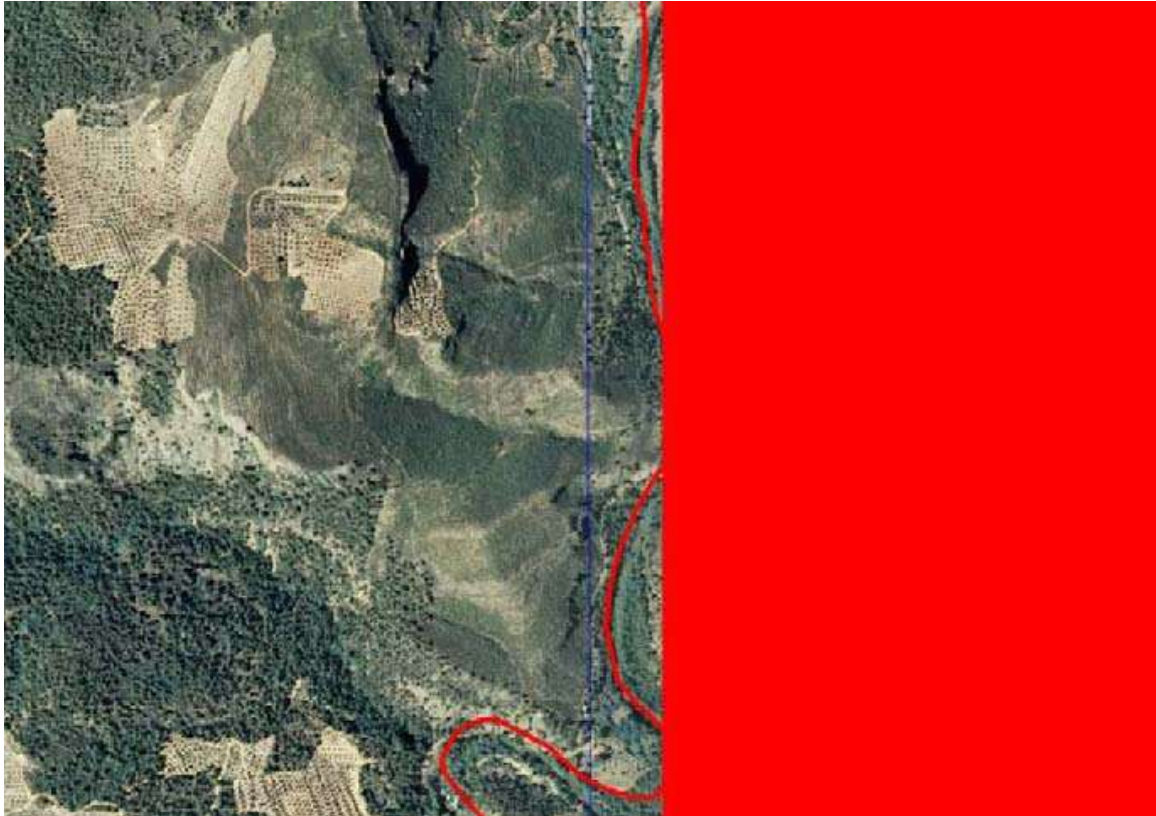
Fig. 11. Ejemplo de incidencia. Falta de imagen ortorrectificada en territorio andaluz.
