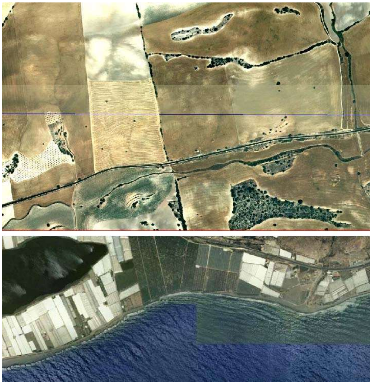
Fig. 10. Ejemplo de incidencia. Discontinuidad radiométrica en el contacto entre diferentes hojas. Zona interior y zona de mar.
