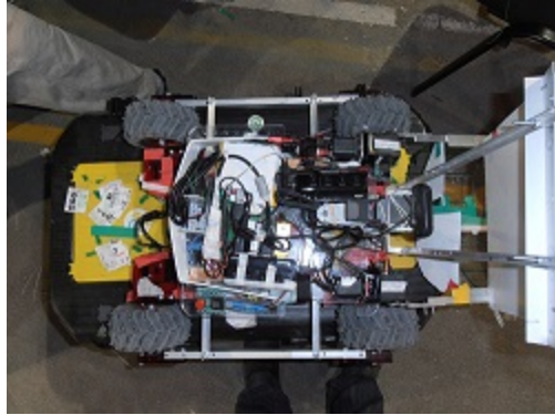
Fig. 8. Ubicación de los componentes (Beagle, USB4Butia, hubs, etc)
