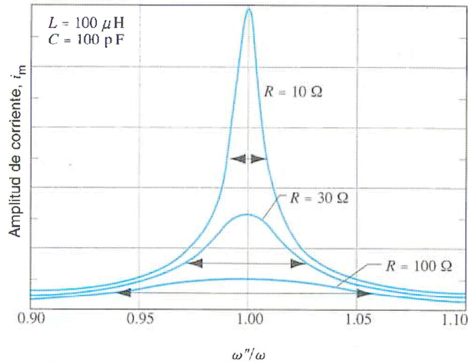
**FIGURA 36-13.** Curvas de resonancia para el circuito oscilatorio forzado de la fig. 36-12a. Las tres curvas corresponden a diferentes valores de la resistencia del circuito. Las flechas horizontales indican el ancho de la “agudeza” de cada resonancia.
