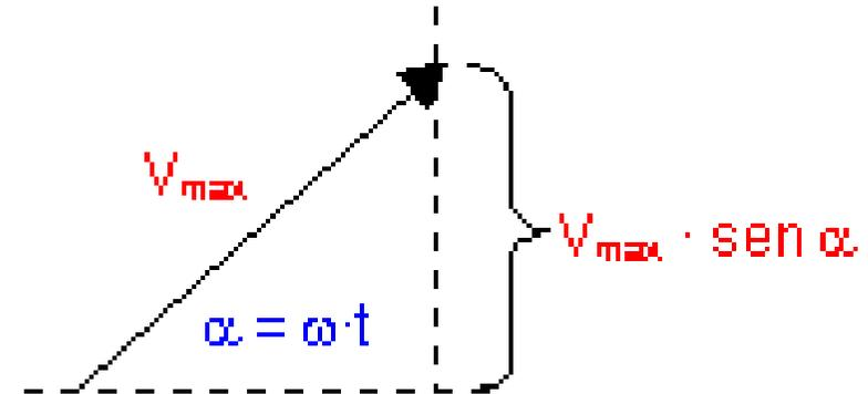
y su representación gráfica corresponde a la proyección sobre el eje vertical de un vector  $V_{\text{MAX}}$  que gira con velocidad angular  $\omega$ .
