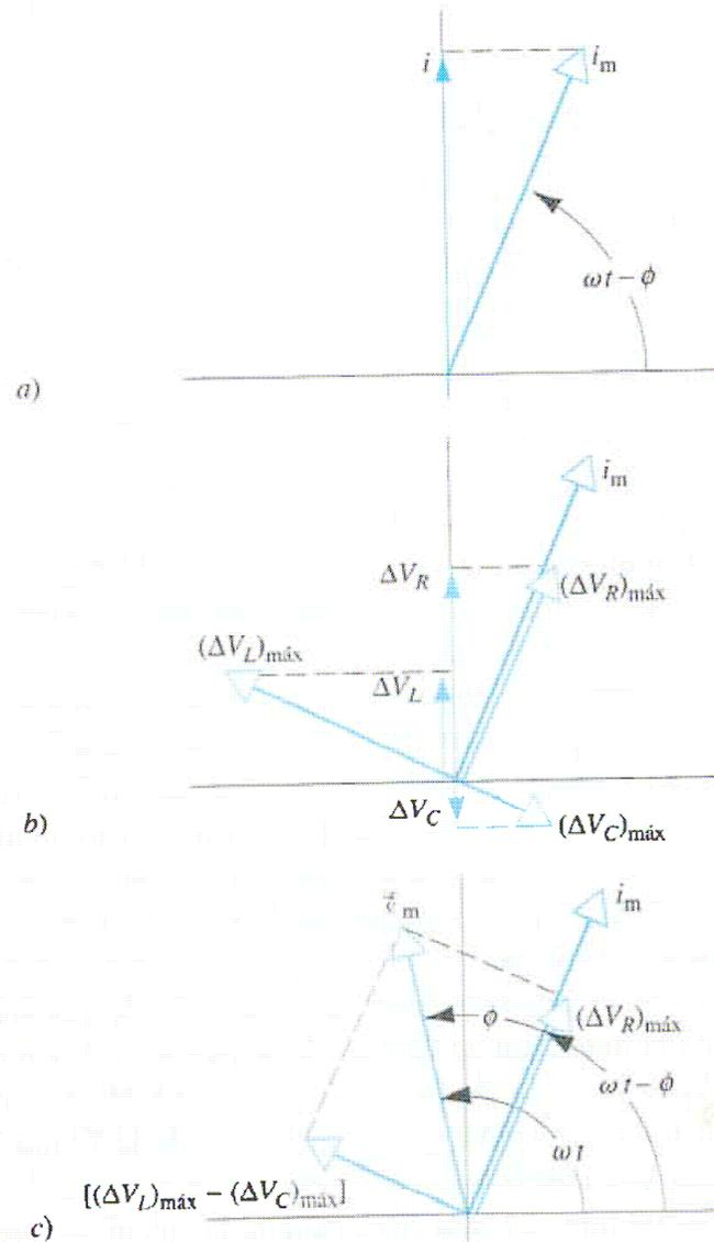
**FIGURA 37-5.** a) Fasor que representa la corriente alterna en el circuito  $RLC$  de la figura 37-1. b) Fasores que representan las diferencias de potencial en el resistor, capacitor e inductor. Nótese sus diferencias de fase respecto a la corriente. c) Se incluyó un fasor que representa la fuerza electromotriz interna.
