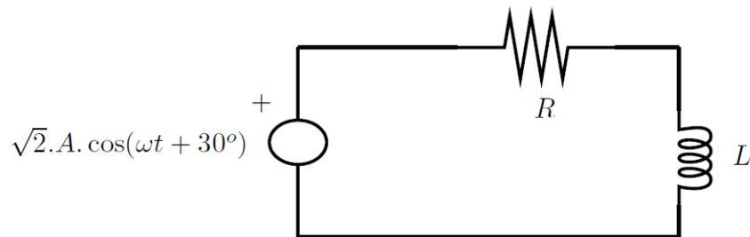
Se considera el circuito de la figura, funcionando en régimen sinusoidal a pulsación  $\omega$ .
