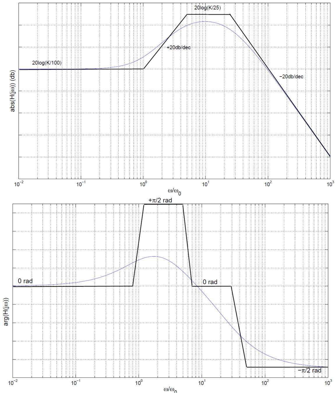
Figura 3: Diagramas de Bode real y asintótico del Problema 1.
