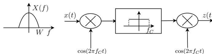
La figura muestra el espectro de la señal  $x(t)$ , de banda acotada  $W \ll f_C$ , y un sistema de modulación que incluye un filtro pasabajos ideal. Indicar cuál de lo siguientes espectros corresponde a la señal  $z(t)$ . Justificar!!
