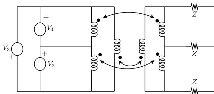
Se considera el circuito trifásico de la figura, donde el sistema de fuentes es equilibrado y perfecto, funcionando a  $50\text{Hz}$ . Los transformadores son ideales, cumpliéndose  $n_1/n_2 = 2$ . La carga trifásica consiste en tres cargas idénticas de impedancia  $Z$ , inductiva. Se pide compensar la potencia reactiva consumida al sistema de fuentes.
