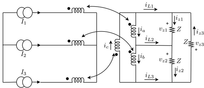
Se considera el circuito de la figura, en el cual los transformadores son ideales y la impedancia  $Z = R + jL\omega$ . Se cumple que:  $R = \frac{5}{\sqrt{3}}\Omega$ ,  $L = \frac{1}{20\pi}Hy$ ,  $\frac{n_1}{n_2} = \frac{1}{\sqrt{3}}$ ,  $\omega = 100\pi$ ,
