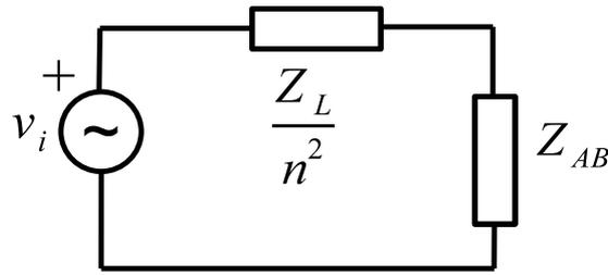
Figura 6: Equivalente monofásico
