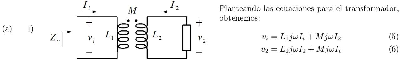
Por otro lado, en el secundario se cumple  $v_2 = -Z I_2$  y despejando  $I_2$  de (6) obtenemos:
