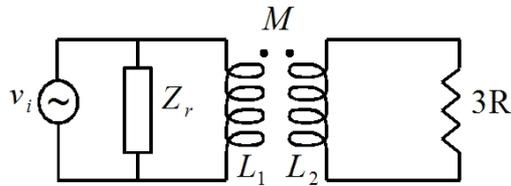
Análogamente que para la parte b del ejercicio, si elegimos  $Z_r$  como un condensador de valor  $\tilde{C} = \frac{1}{L_1\omega^2}$ , la impedancia vista por la fuente será  $Z_v = \left(\frac{L_1}{L_2}\right) 3R$ , por lo cual no hay potencia reactiva entregada por las fuentes.
