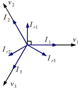
$$\begin{cases} I_1 = 46mA \angle 0^\circ \\ I_2 = 46mA \angle 120^\circ \\ I_3 = 46mA \angle 240^\circ \end{cases} \quad (12)$$
