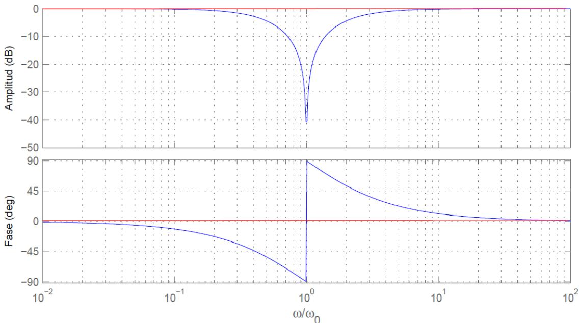
Figura 1: Diagramas de Bode asintóticos y reales de  $H_1$ .
