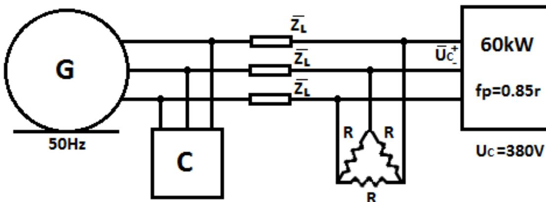
Un generador trifásico de frecuencia 50Hz alimenta una carga trifásica equilibrada mediante una línea de impedancia  $Z_L = (0, 1 + j0, 1)\Omega$ .
