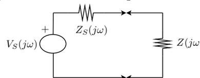
Figura 2: Circuito equivalente.
