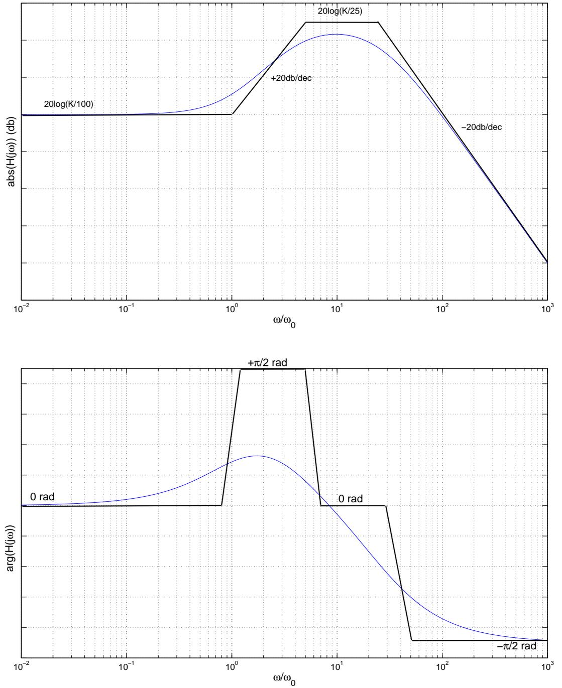
Figura 6: Diagramas de Bode real y asintótico del Problema 1.
