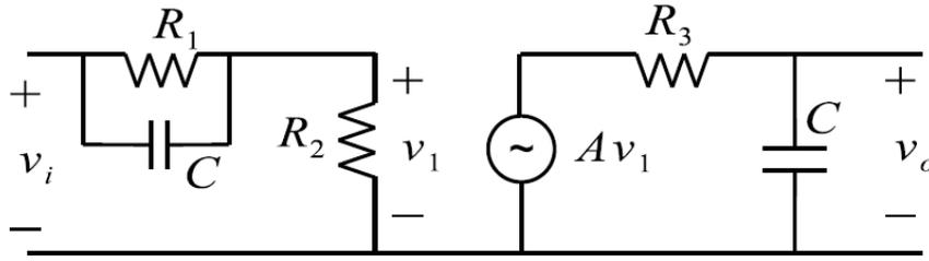
tensión  $v_1$ . Pasamos al circuito equivalente en fasores. Aplicando un divisor de tensión en la malla de la entrada, obtenemos
