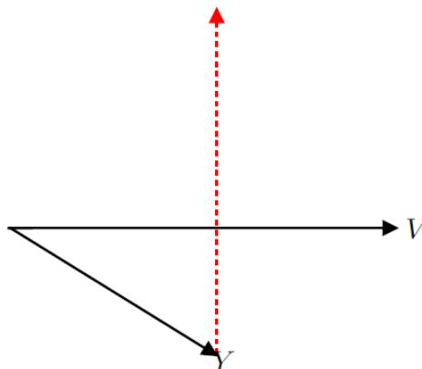
vi) Debo minimizar el módulo de la corriente  $I$ . Observando su lugar geométrico se puede ver que esto ocurre cuando  $I = I_R$  ( $I_L + I_C = 0$ ). Entonces :  $C = \frac{1}{\omega^2 L}$ .
